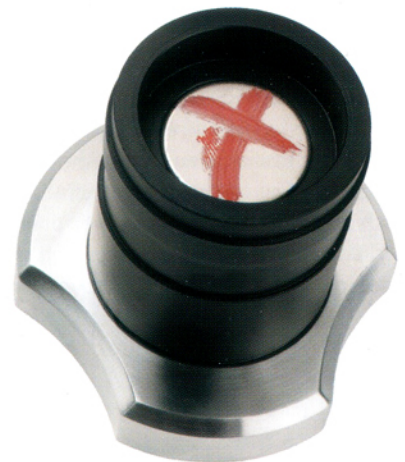
Dieser mit einem roten Kreuz markierte Fuß gehört vorn rechts unter den Baltic M: Sein Magnet ist schwächer, um die ungleiche Gewichtsverteilung des Chassis auszugleichen
